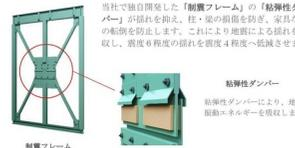
当社で独自開発した「制震フレーム」の「粘弾性ダンパー」が揺れを抑制し、壁・窓の割損を防止。家具などの転倒を防止します。これにより地震による揺れを吸収し、震度6程度の揺れを震度4程度へ低減させます。
